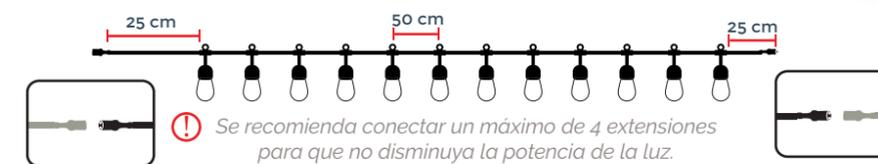
⚠ Se recomienda conectar un máximo de 4 extensiones para que no disminuya la potencia de la luz.
